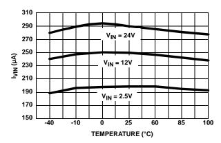
FIGURE 5.  $V_{\text{IN}}$  CURRENT
