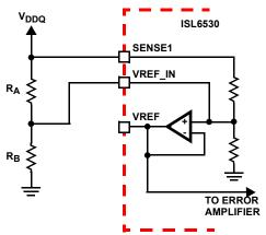
FIGURE 4. V<sub>TT</sub> REFERENCE OVERDRIVE
