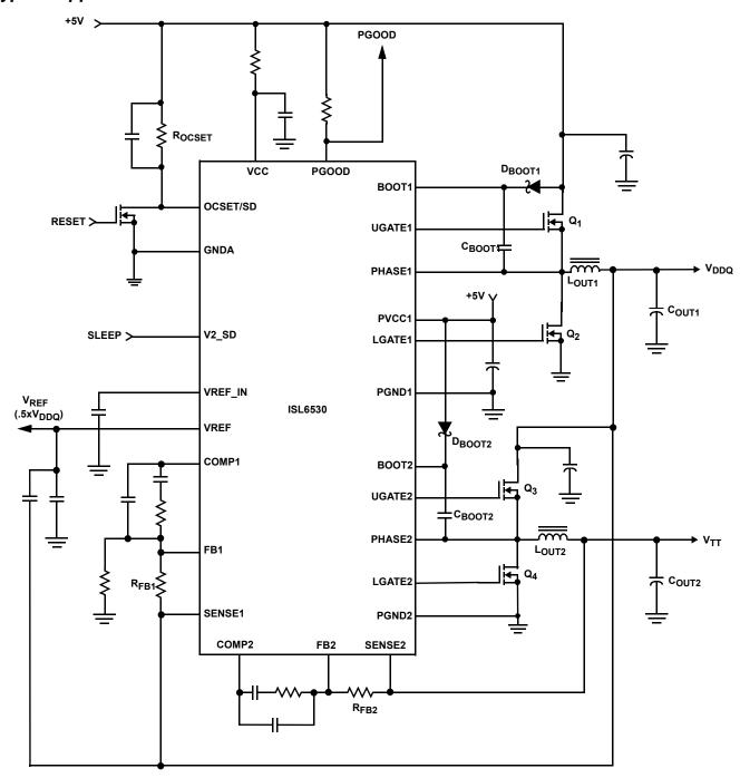
FIGURE 1. TYPICAL APPLICATION FOR ISL6530
