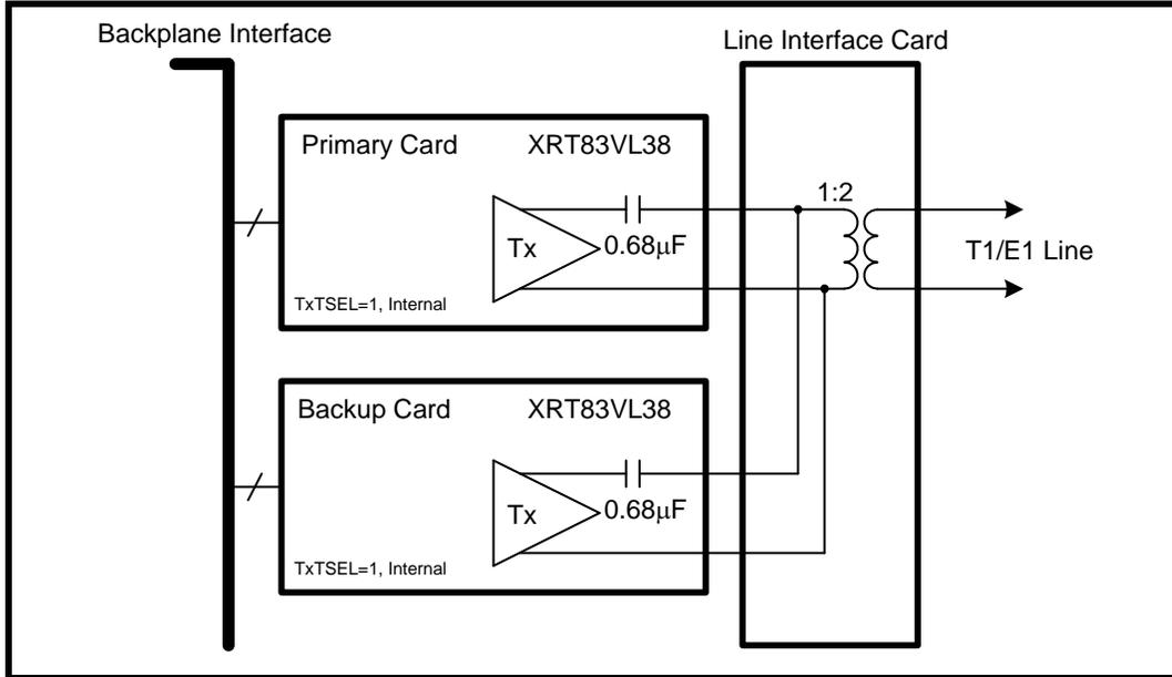
**RECEIVE 1:1 & 1+1 REDUNDANCY**
