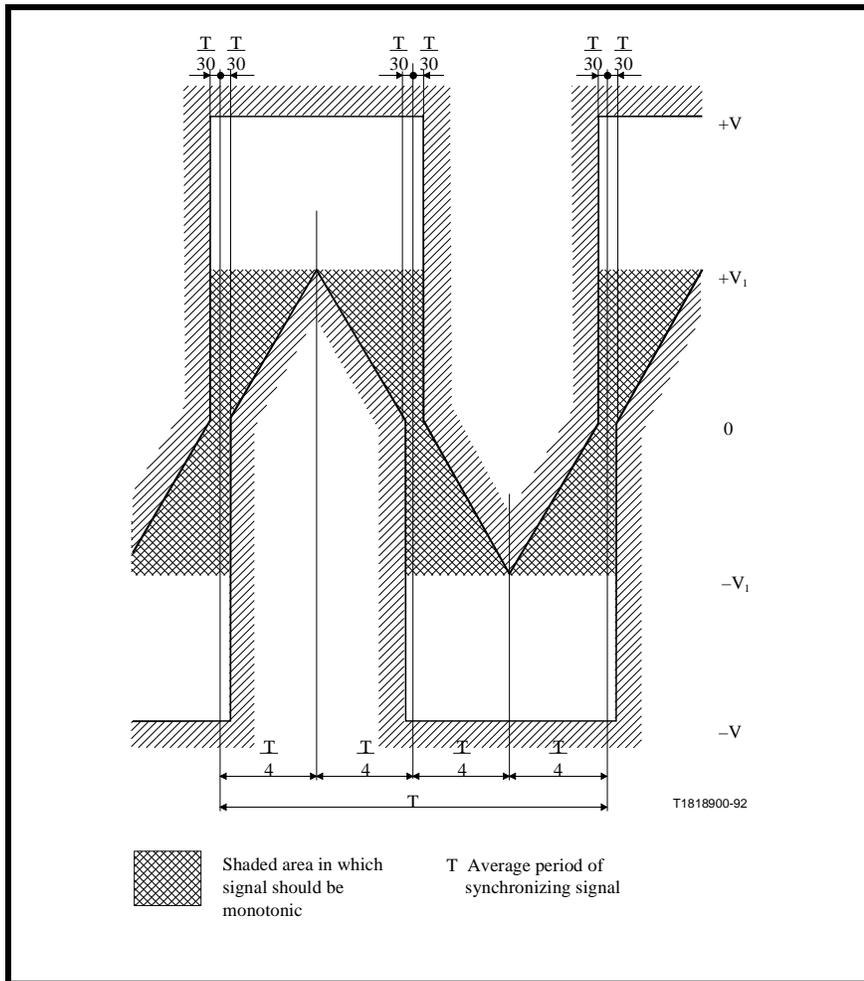
TABLE 53: E1 SYNCHRONOUS INTERFACE TRANSMIT PULSE MASK SPECIFICATION
