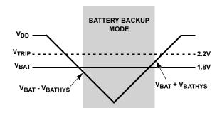
FIGURE 9. BATTERY SWITCHOVER WHEN  $V_{BAT} < V_{TRIP}$
