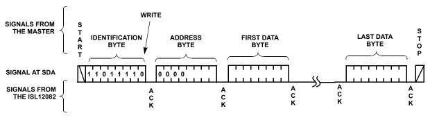
FIGURE 14. SEQUENTIAL BYTE WRITE SEQUENCE
