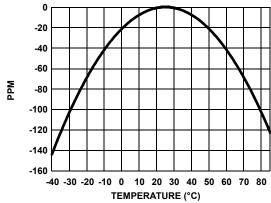
FIGURE 17. RTC CRYSTAL TEMPERATURE DRIFT
