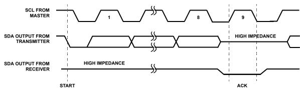
FIGURE 13. ACKNOWLEDGE RESPONSE FROM RECEIVER
