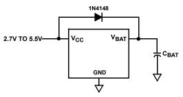
FIGURE 20. SUPERCAPACITOR CHARGING CIRCUIT
