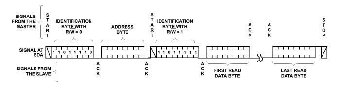
FIGURE 16. SEQUENTIAL BYTE READ SEQUENCE
