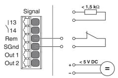
Figure 24 External wiring versions, enable SLEEP MODE
